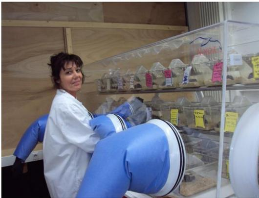
L'installation des matériels NOROIT "s'est très bien passée". Les contrôles ont été effectués à l'installation. Pour les isolateurs (localisation des fuites, étanchéité de l'isolement, contrôle de stérilité, comptage particulaire), et les hottes (contrôle du filtre, visualisation du flux), puis un rapport de mise en service est délivré à l'entreprise.
